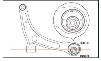
3. Reinstall the lower control arms to vehicle. 將前下控制臂裝回車輛。
