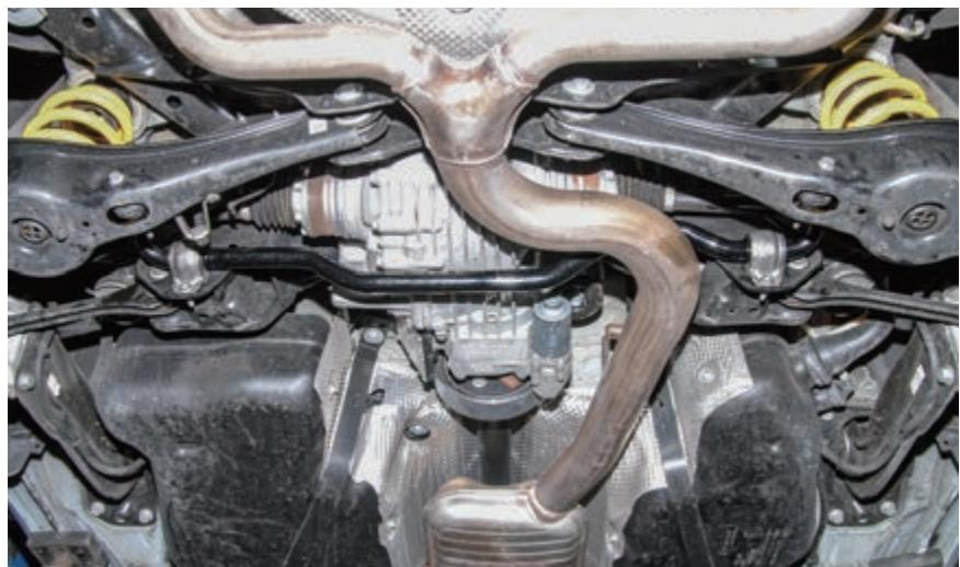
後防傾桿安裝無須拆卸周邊零件，可直接更換
