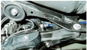
請依照圖示方向安裝後防傾桿,將安裝完畢後必須電腦四輪定位校正
