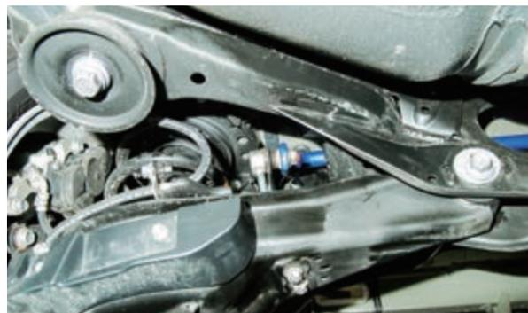
請依照圖示方向安裝後防傾桿，將安裝完畢後必須電腦四輪定位校正
